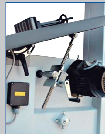
Inclinazione piano con volantino cremagliera Handwheel tilting table with rack-pinion Table inclinable avec petit volant Tischneigung durch Zahnstange und Handrad Mesa inclinable por volante
